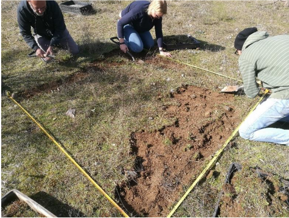
Figura 8. Extracción de bloques de suelo en las áreas de muestro de dimensiones 200x200x5 cm.
